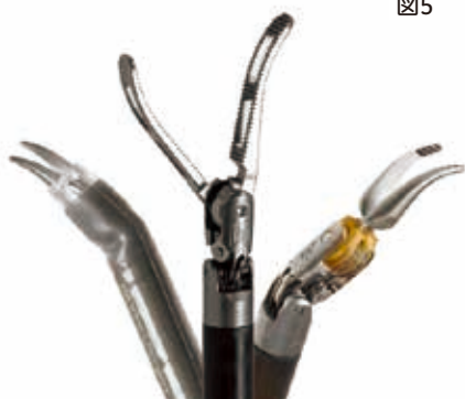
▲多くの関節機能を有するインストゥルメント（ロボット手術の鉗子）
